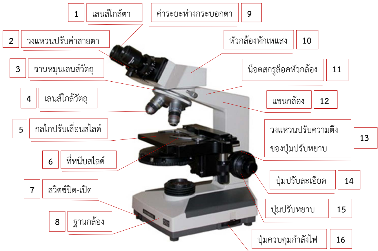
รูปที่ 1 ส่วนประกอบสำคัญของกล้องจุลทรรศน์ ใช้ตัวอย่าง ยีหื้อ โอล์มปัส รุ่น CH2
